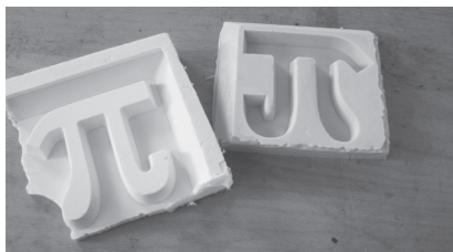
figuur 5 De positieve mal van styrenefoam (links) en de negatieve mal van siliconenrubber (rechts)
